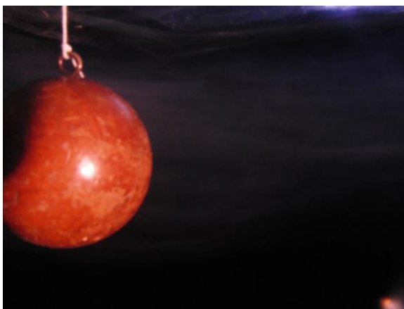
図7 球体を 気流中に置いたとき
