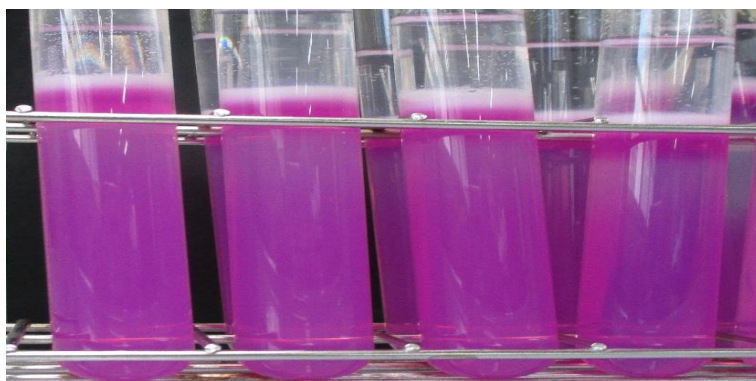
図 4 濃アンモニア水滴下前の強塩基性ゲル(実験β-①)
