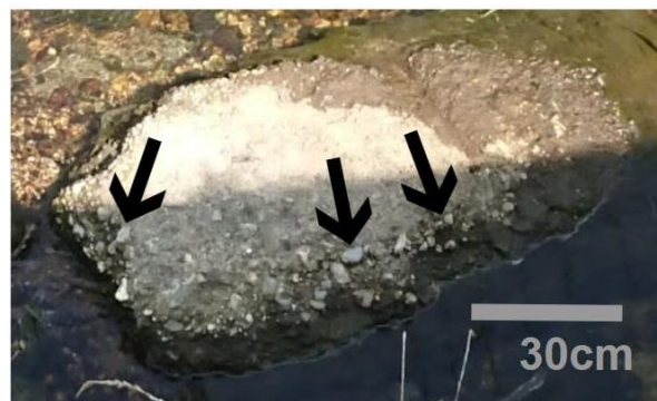
図17 風化して骨材(矢印)が露になったコンクリートの礫
