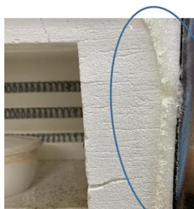
図5. 電気炉のふちに付着した固体
