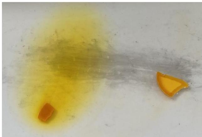
図7 実験2の様子 (左:塩化鉄(III) 右: $\text{Fe}^{3+}$ 添加樹脂)
