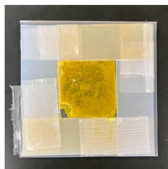
a シリコンゴムの型に流し込む様子    b シリコンゴムの型で厚さを均一にした生成物
