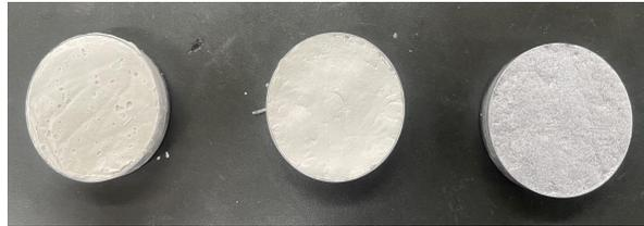
図5 完成品 左から① $\text{Al}_2\text{O}_3$ 、② $\text{BiOCl}$ 、③ $\text{Al}$
